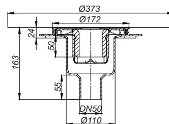
Diamètre du trou à ménager : 120 mm
