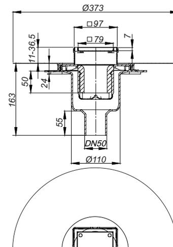
Diamètre du trou à ménager : 120 mm
