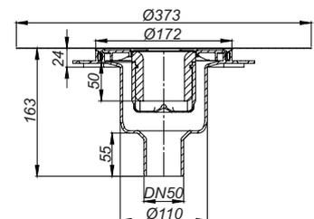
Diamètre du trou à ménager : 120 mm
