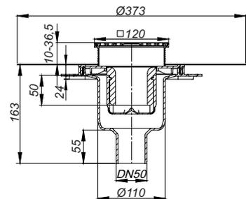
Diamètre du trou à ménager : 120 mm
