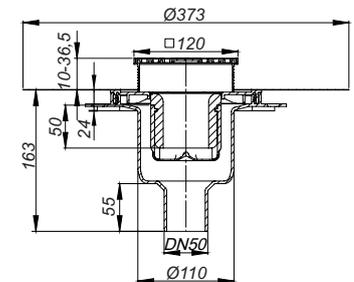
Diamètre du trou à ménager : 120 mm
